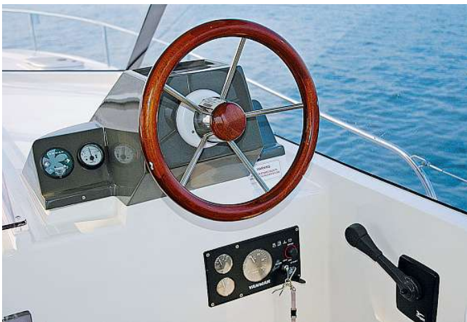
Die Armaturen Brett-Gestaltung ist sicherlich nicht das Gelbe vom Ei. Zwischen den Lenkschlägen liegen sechs Ruderdrehungen
