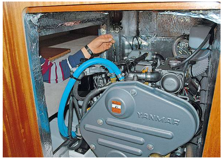
Der vierzylindrige Yanmar-Diesel schöpft seine 39,7 kW (54 PS) aus 2,19 Liter Hubraum. Die Maschine ist von drei Seiten zugänglich
