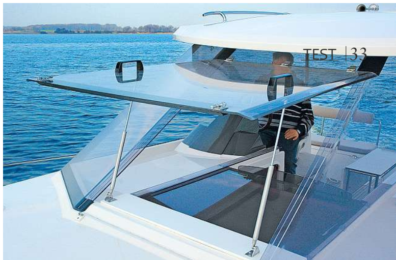
Keine Ideallösung: Die 8 mm starken Cockpitfenster bestehen aus Acrylglas. Die mittlere Scheibe lässt sich auf 80 cm Breite öffnen
