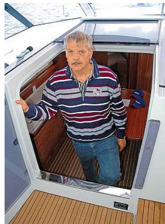
Pluspunkt: Der Saloneingang ist 76 cm breit. Ein fehlender Handlauf wird nachgerüstet
