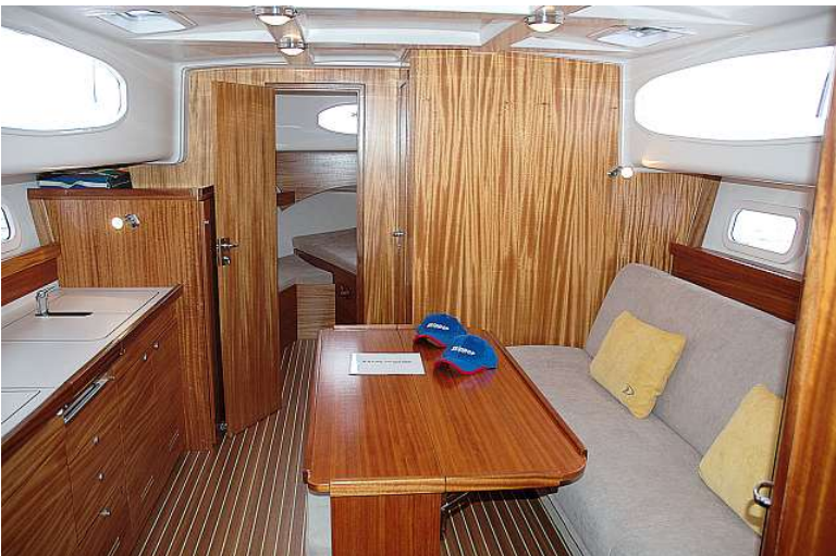
Blick in den Wohntrakt mit 1,91 m Stehhöhe: Die bequeme Couch kann bei Bedarf in eine zusätzliche Kojе umfunktioniert werden
